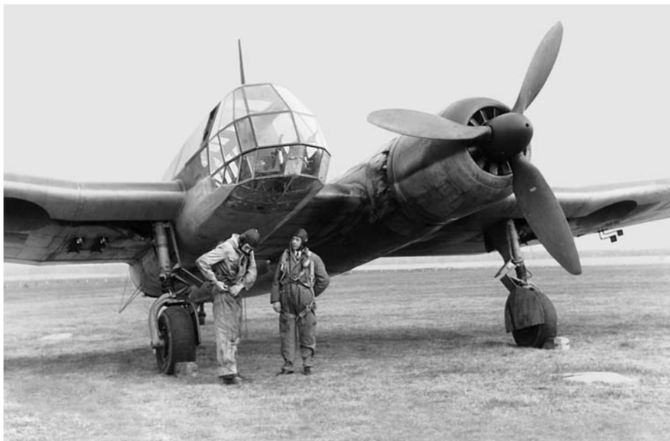
Разведчик BV-141 фирмы «Блом и Фосс» не получил большого распространения. Этот самолет интересен своей необычной конструкцией: место второго мотора занимала кабина экипажа. Такая «несимметричная» компоновка является уникальным случаем в истории самолетостроения
